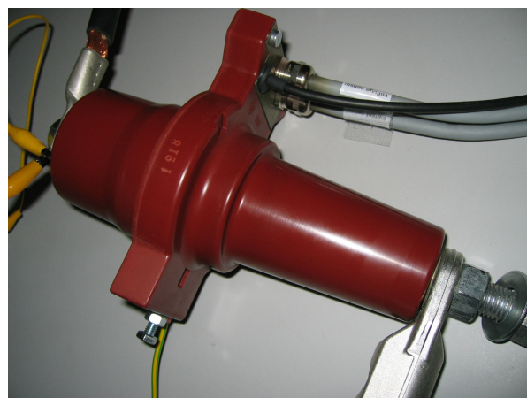
Figur 10, Gennemføring med indbygget kapacitet (Fab. ABB) foto fra lab.test
