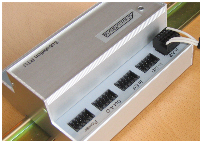
Figur 3, RTU med fjederklemme-stik, Her er det stik af fabrikat Weidmüller.
